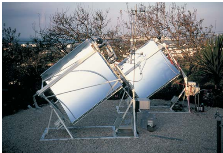
Wasserdesinfektion in Rinnenkollektoren in der Villa Solaris, Michael. Mitzel, Spanien und Portugal
